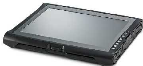
Планшетный ПК с дисплеем 33,8 см (13,3") и Windows Embedded Standard 7
