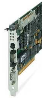
Ведущее устройство PCI
