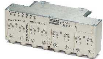
8 дискретных входов и 8 считываемых дискретных выходов
