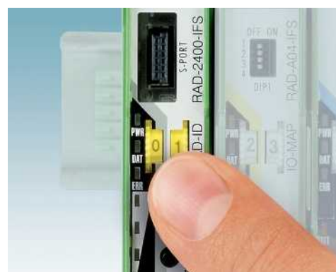
Простота адресации - вращением колёсика настройки на радиомодуле
