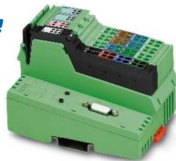
Разъем D-SUB, 8 дискретных входов и 4 дискретных выхо- да
