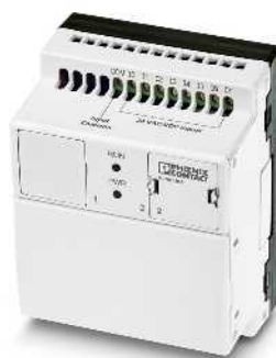
24 В пост. тока, 8 дискретных входов, 2 аналоговых входа и 4 дискретных выхода PNP
