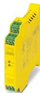
сертифицированное SIL 3 реле сопряжения для безопасного включения
